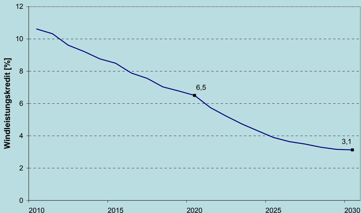
**Abbildung 4.19:** Leistungskredit der Windkonverter in der Referenzprognose (Ra)
